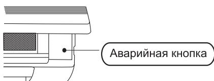
Эта кнопка может использоваться как чрезвычайная мера, для включения\выключения устройства, когда ПДУ не доступен.
