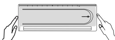
Слегка выдвиньте обе стороны воздушной сетки входного отверстия в основании и тяните в сторону до упора.
