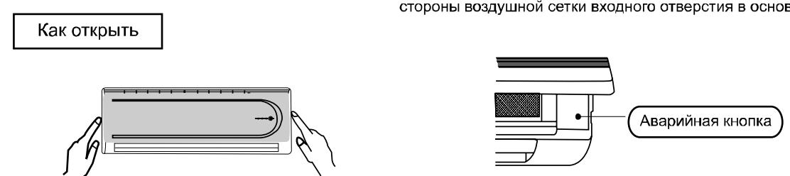
Слегка выдвиньте обе стороны воздушной сетки входного отверстия в основании и тяните в сторону до упора.
