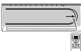
Нажатие на каждую кнопку ПДУ запускает процесс отсылки сигнала на внутреннее устройство кондиционера. В свою очередь, получив новую команду от ПДУ кондиционер посыпает сигнал обратно. При удачной отправке сигнала и получении подтверждения раздается звуковой сигнал, подтверждающий новую команду.
